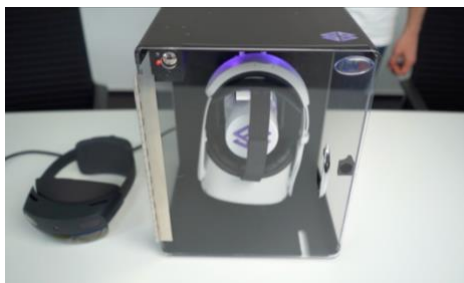
Abb. 4: „VR Headset Reinigung mit UV-Licht in der Cleanbox“ von 3spin, CC BY-SA 4.0 , 30.06.2021
